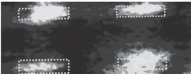
**Рис. 6.** М.р.с.м.-изображение участка массива микрополосок. Частота накачки 5.8 ГГц, подмагничивающее поле 30 мТл, расстояние между зондом и образцом 1 мкм. Пунктирными линиями показаны положения микрополосок. Размер кадра  $11 \times 4$  мкм.
